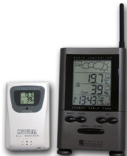
▼ Abb. 19: Der außerhalb eines Wohnhauses angebrachte Sensor misst die Temperatur sowie die Feuchtigkeit der Luft und überträgt die Messwerte per Funk zu einer Basisstation. Derartige Funkwetterstationen sind bei zahlreichen Anbietern preiswert erhältlich.
